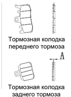
Рис. 27 Проверка тормозных колодок
