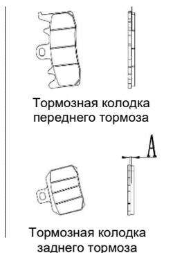
Проверьте минимальную толщину тормозной колодки заднего тормоза (A).
