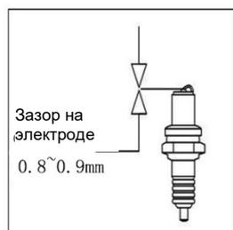
**Модель свечи зажигания: CR9EH-9 (NGK),**
