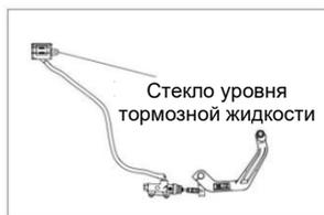
Рис. 32 Проверка уровня тормозной жидкости заднего тормоза
