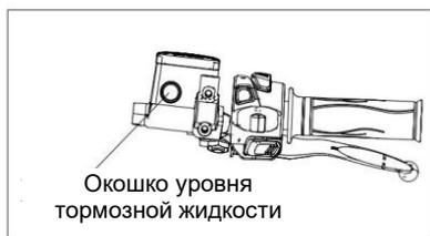
Рис. 28 Проверка уровня тормозной жидкости переднего тормоза
