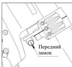
Рис. 6 Передний замок
