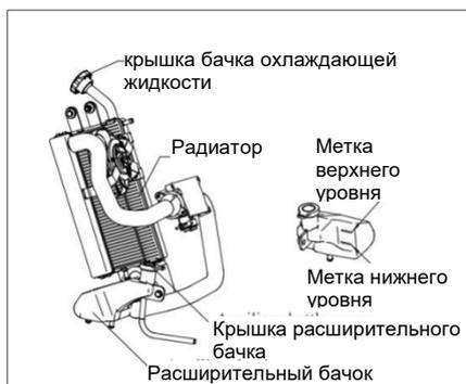
Рис. 34 Система охлаждения
