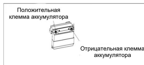
Рис. 33 Аккумуляторная батарея
