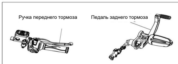
Рис. 15 Схема расположения тормозов
