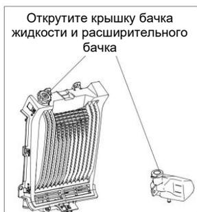
Рис. 35 Добавление охлаждающей жидкости
