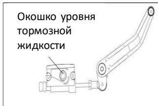
Отрегулируйте положение размещения мотоцикла так, чтобы тормозная жидкость в бачке тормозной жидкости находилась в горизонтальном положении, и проверьте уровень тормозной жидкости по окошку уровня жидкости.
