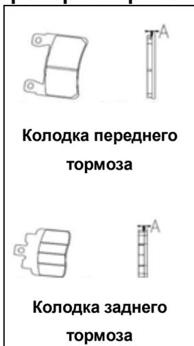
Проверьте минимальную толщину тормозных колодок (A).
