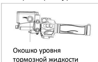
Отрегулируйте положение установки мотоцикла так, чтобы тормозная жидкость в бачке тормозной жидкости находилась в горизонтальном положении, и проверьте уровень тормозной жидкости по окошку уровня жидкости. (Рис. 26)
