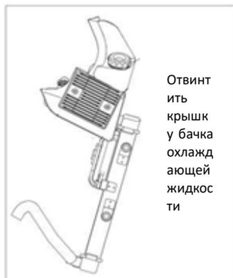
Отвинтить крышку у бачка охлаждающей жидкости
