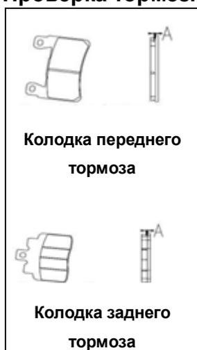
Проверьте минимальную толщину тормозных колодок (A).
